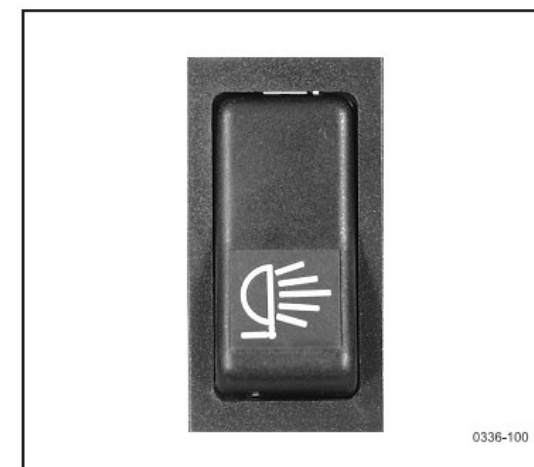
336 Công tắc đèn sau
